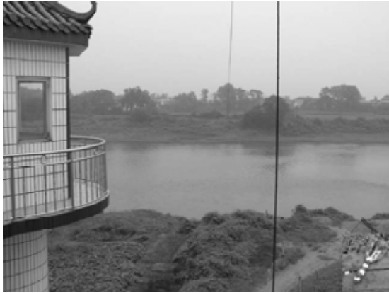
写真2 寧郷水文站における湘江。対岸まで張られたワイヤーに写真右下に示した流速計を懸架して流量観測を行う
