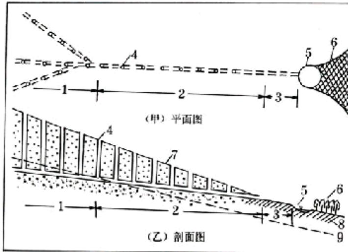
坎儿井は天山山脈の融雪水を源とする扇状地の地下水を長い人工トンネルを穿ってオアシスに導水する伝統的システムである。持続可能なシステムであるが、維持・管理が大変であるため最近では井戸、開水路による導水が盛んに行われ、坎儿井は衰退しつつある。同時に地下水位は低下を続けているという。
