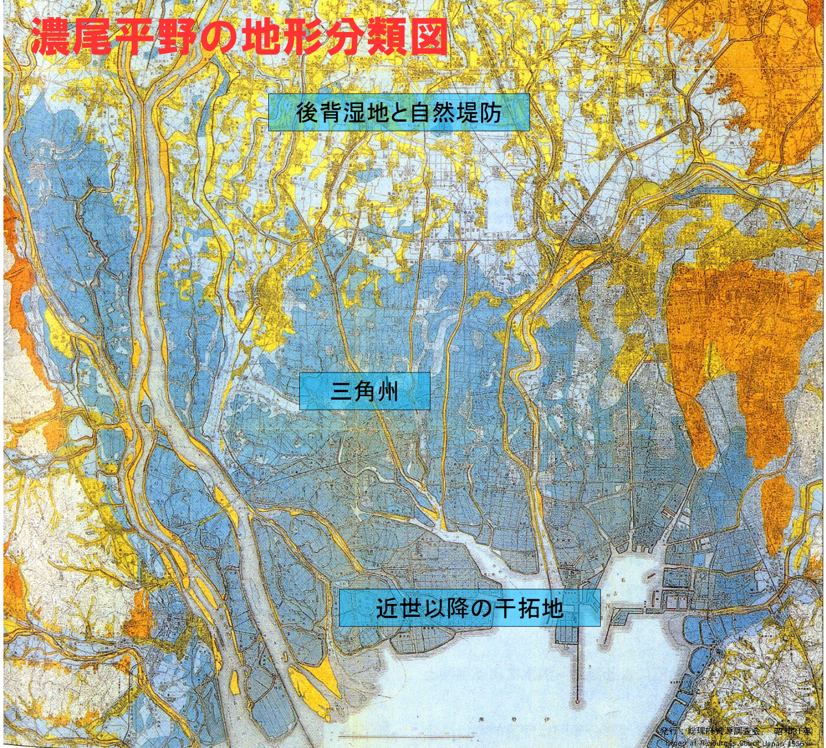
図1 木曾川下流濃尾平野水害地形分類図(大矢, 1956) 部分, 原図1:50,000を37%に縮小
