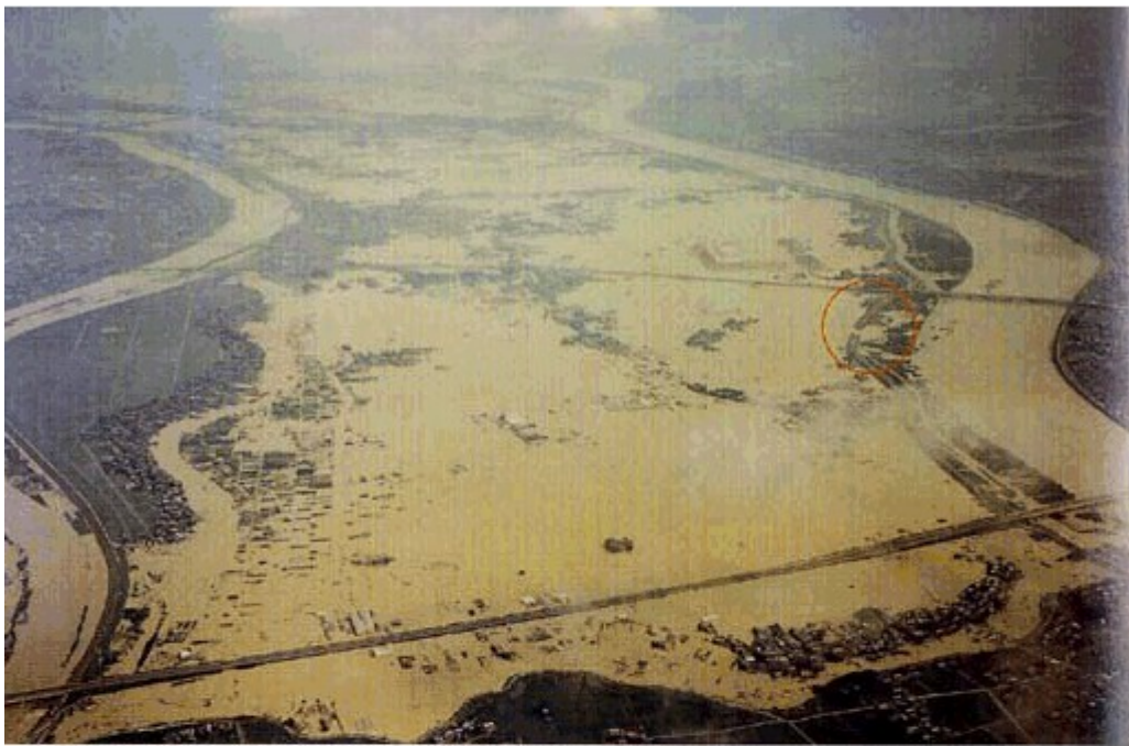
○昭和51年9月12日、台風17号の豪雨で、海津町の少し上流にある安八町の長良川の堤防が切れました。赤丸印の堤防が切れたところです。写真の下の方は稲束輪中で、輪中壁をしめきったため浸水しませんでした。
