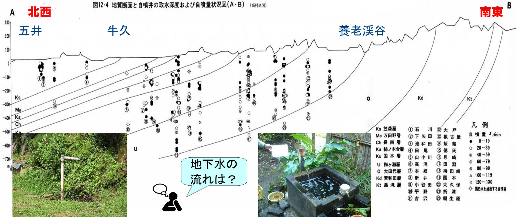
養老川の地質断面と自噴井の採水深度(高村、1972)
