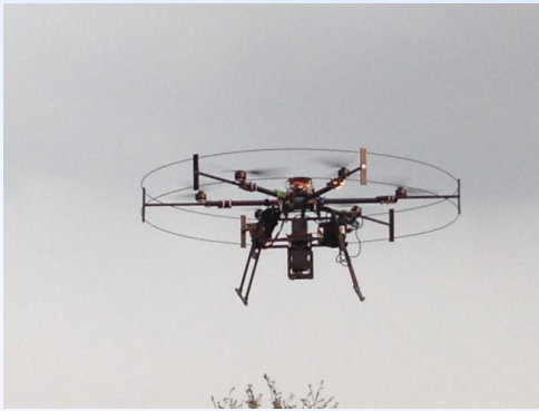
ミニサーベイヤーMS-6L ハイパースペクトルカメラ搭載
