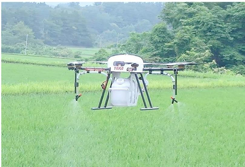
東光鉄工(株)開発の農薬散布ドローン
