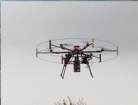
ミニサーベヤーMS-6L ハイパースペクトルカメラ搭載
