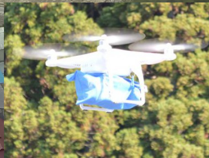
DJI PHANTOM2 空間線量率測定中
