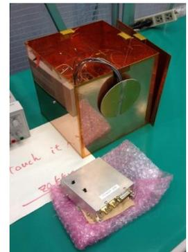
電子密度電子温度プローブ (EDTP)
