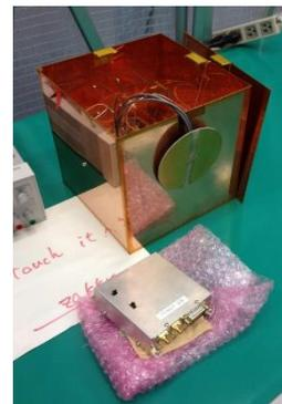
電子密度、電子温度プローブ(EDTP)
