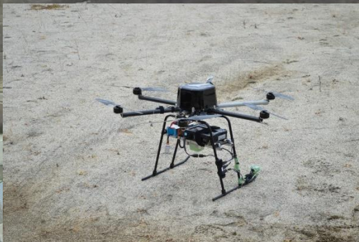
電動ヘキサコプター ミニサーベイヤーMS-6L
