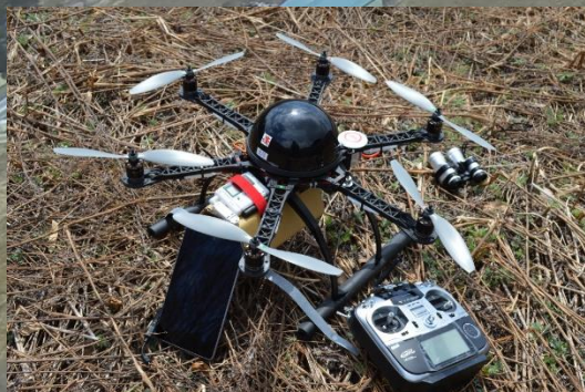
空間線量率測定システム を搭載したヘキサコプター
