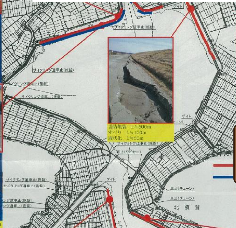
堤防亀裂、すべり、崩落、沈下 L \approx 400m
