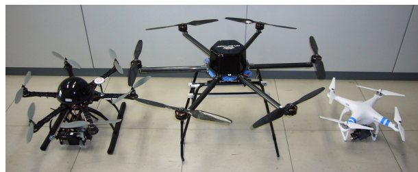
左：ラジコンショップによるカスタム機、ジンバル、シャッター機構付 中：センサーペイヤーMS-6L、千葉大学開発機、自律飛行可能 右：DJI PHANTOM2 10万円前後で導入できる普及機
