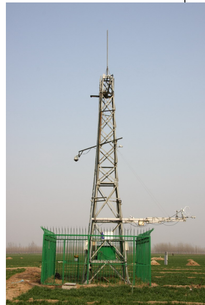
位山站水热通量涡 度相关观测系统
