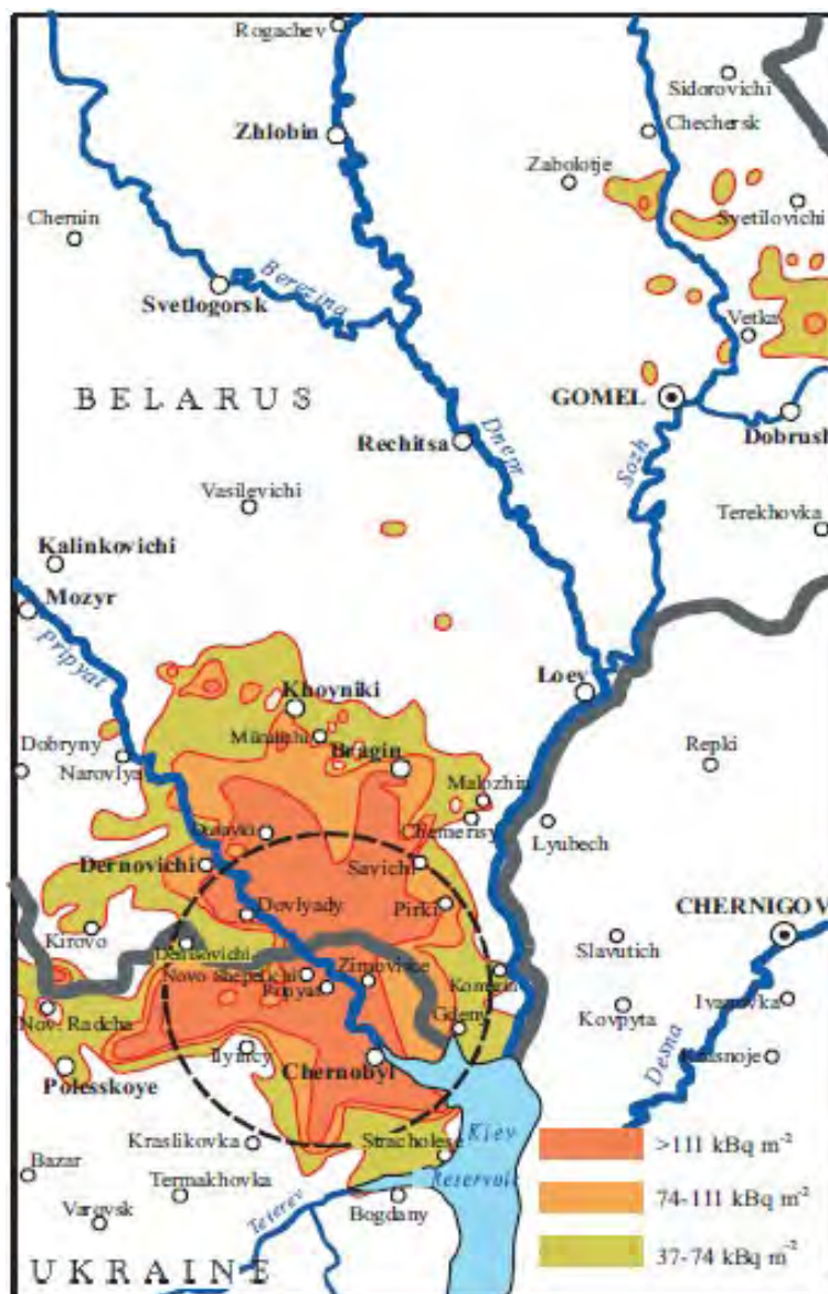
図3.8.: ^{90}\text{Sr} の地表への沈着量マップ。[文献 3.4より引用]【縦軸の単位は \text{kBq/m}^2 。ベラルーシとウクライナにまたがる地域。】
