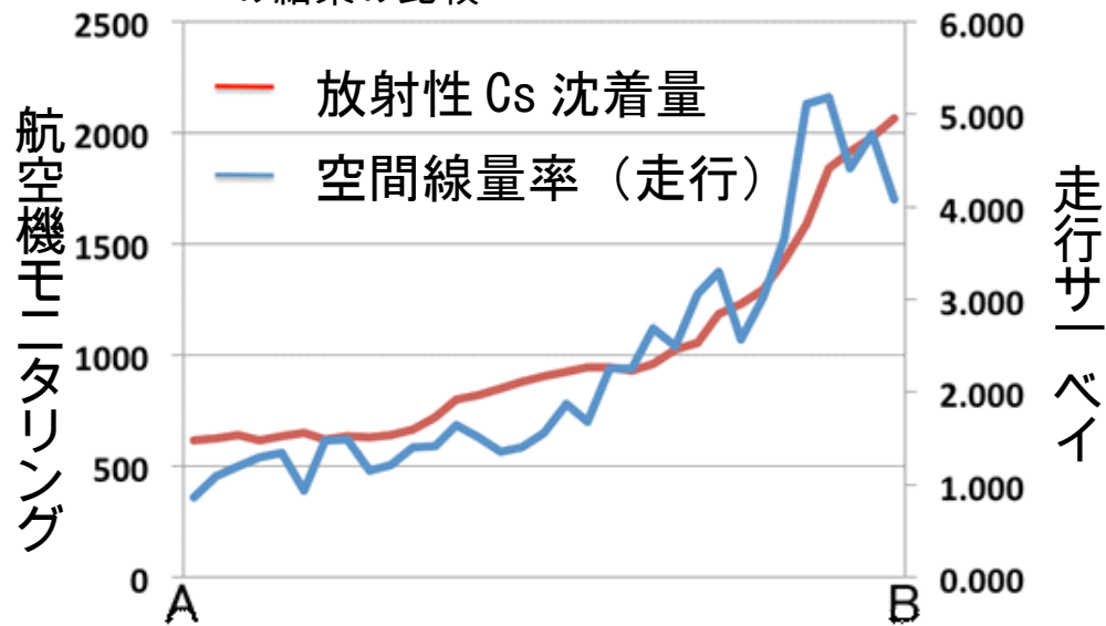
航空機モニタリングと走行サーベイの結果の比較 (KBq/m 2 ) (μSv/h)
