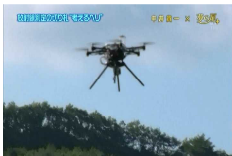
図2 山木屋小学校におけるUAV実験。歩行できない斜面林の放射能計測に最新の科学技術を導入。千葉大学野波研究室Mini Surveyorによる実験(2012年8月、TBSで放映)
