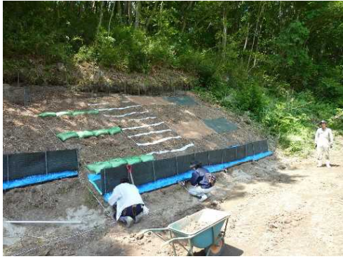
図3 法面から畑への移行部分における放射性物質移行および侵食防止実験。
