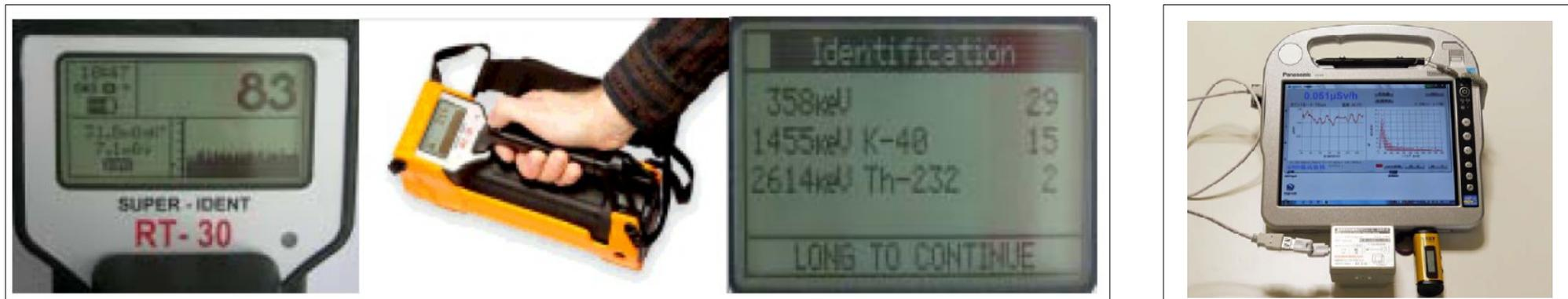
チェコ製の  $\gamma$  線スペクトロメーター RT-30 (左) と国産の GPS 連動型空間線量率自動記録システム HSF-1 (右) を使用。
